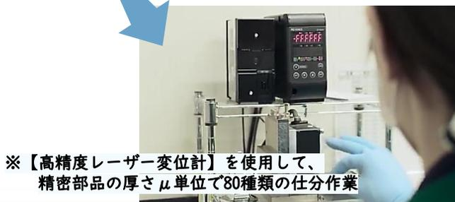
※【高精度レーザー変位計】を使用して、
