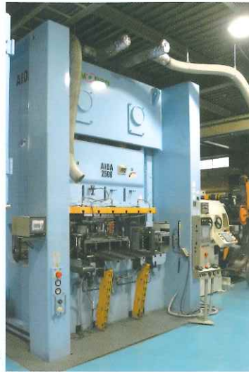
250t サーボプレス 順送ライン The product normal flow of 250 tons servo press machine
