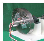
スリップリングを利用した回転体計測
