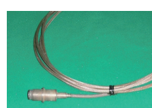
高温用センサ(加速度計、圧力計、ひずみ計)を利用した計測
