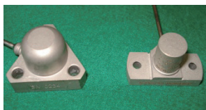
高温用センサ(加速度計、圧力計、ひずみ計)を利用した計測
